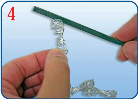
**4.** Para que las piezas de metal fundido le ajusten perfectamente, antes de colocarlas repase los cantos y elimine las posibles rebabas e impurezas con la ayuda de una lima pequeña.
